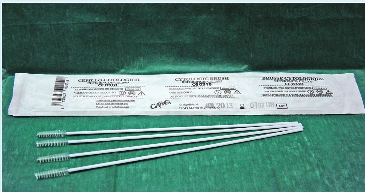
Consta de una parte central cilíndrica de plástico, a la cual va unida un escobillón de nylon enrollado sobre un alambre de acero inoxidable.
